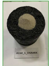
Mesure de la tache au sable
