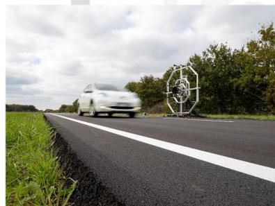
Mikrofonarray-Messung einer Vorbeifahrt des Nissan LEAF auf der Prototypenfahrbahnoberfläche
