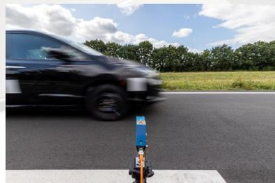
Lichtschränke zur Bestimmung der Fahrzeuggeschwindigkeit während der Vorbeifahrtgeräuschmessung
