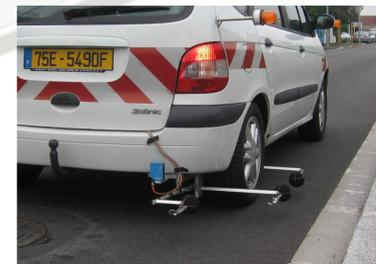
On-board-System zur kontinuierlichen Geräuschmessung (CPX)
