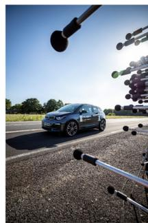
Mikrofonarray-Messungen einer Vorbeifahrt eines BMW i3s (links) und TESLA Model 3 (rechts)
