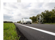
Misura di antenna acustica al passaggio della Nissan LEAF sopra il prototipo
