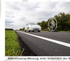
Mikroarray-Messung: einer Vorbeifahrt des Nissan LEAF auf der Prototypenfahrbahnoberfläche
