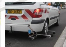
Système embarqué de mesure de bruit en continu (CPK)
