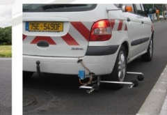
Sistema di misurazione continua del rumore a bordo (CPX)
