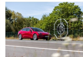
Mikroarray-Messungen: einer Vorbeifahrt eines BMW 1s (links) und TESLA Model 3 (rechts)
