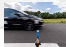
Cella a infrarossi per la misurazione della velocità nelle misure di rumore pass-by
