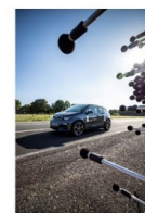
Misura pass-by index su BMW i3 (a sinistra) e Tesla Model 3 (a destra)
