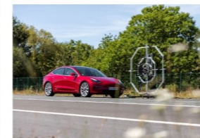
Mikroarray-Messungen: einer Vorbeifahrt eines BMW 13s (links) und TESLA Model 3 (rechts)
