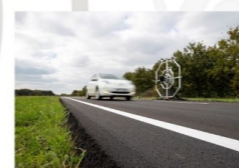
Mesure par antenne acoustique au passage de la Nissan LEAF sur le prototype
