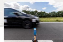
Cellule infrarouge pour la mesure de vitesse lors des mesures de bruit au passage
