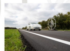
Misura di antenna acustica al passaggio della Nissan LEAF sopra il prototipo
