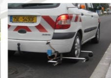
Système embarqué de mesure de bruit en continu (CPX)
