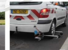
Sistema di misurazione continua del rumore a bordo (CPX)
