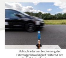
Lichtschranke zur Bestimmung der Fahrzeuggeschwindigkeit während der Vorbeifahrtgeräuschmessung
