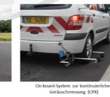
On-board-System zur kontinuierlichen Geräuschmessung (CPX)
