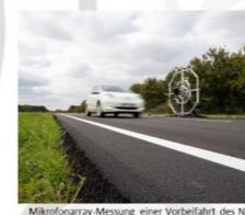
Mikroarray-Messung: einer Vorbeifahrt des Nissan LEAF auf der Prototypenfahrbahnoberfläche
