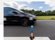
Cella a infrarossi per la misurazione della velocità nelle misure di rumore pass-by
