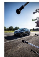
Mesure par antenne acoustique au passage sur BMW i3s (gauche) et Tesla Model 3 (droite)
