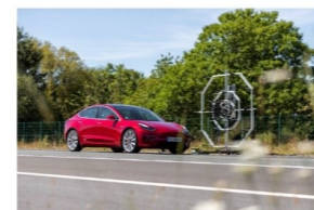
Mesure par antenne acoustique au passage sur BMW i3s (gauche) et Tesla Model 3 (droite)
